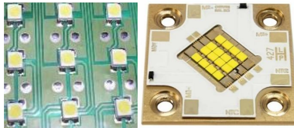
Figura 2a. Leds miniatura | Figura 2b. multichip Led Fuente: internet | Fuente: Osram, 2015
